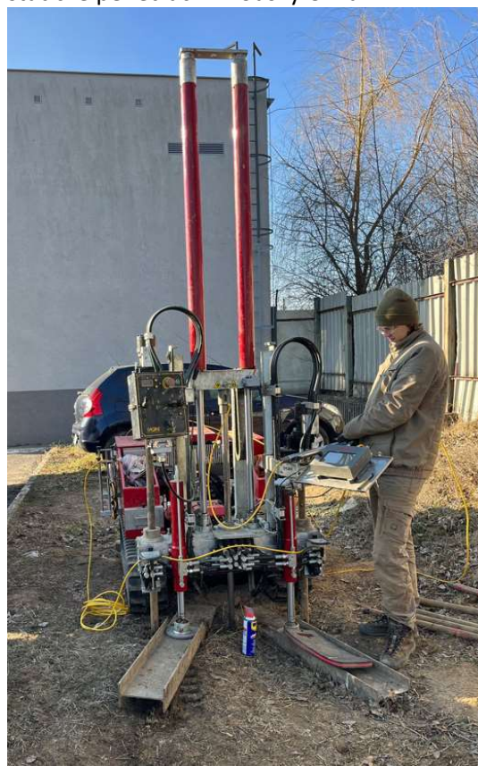
Foto 10: Realizace statické penetrační zkoušky CPTu 2b.
