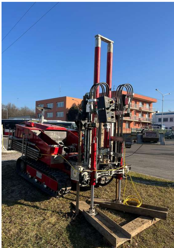
Foto 7: Realizace statické penetrační zkoušky CPTu 1.
