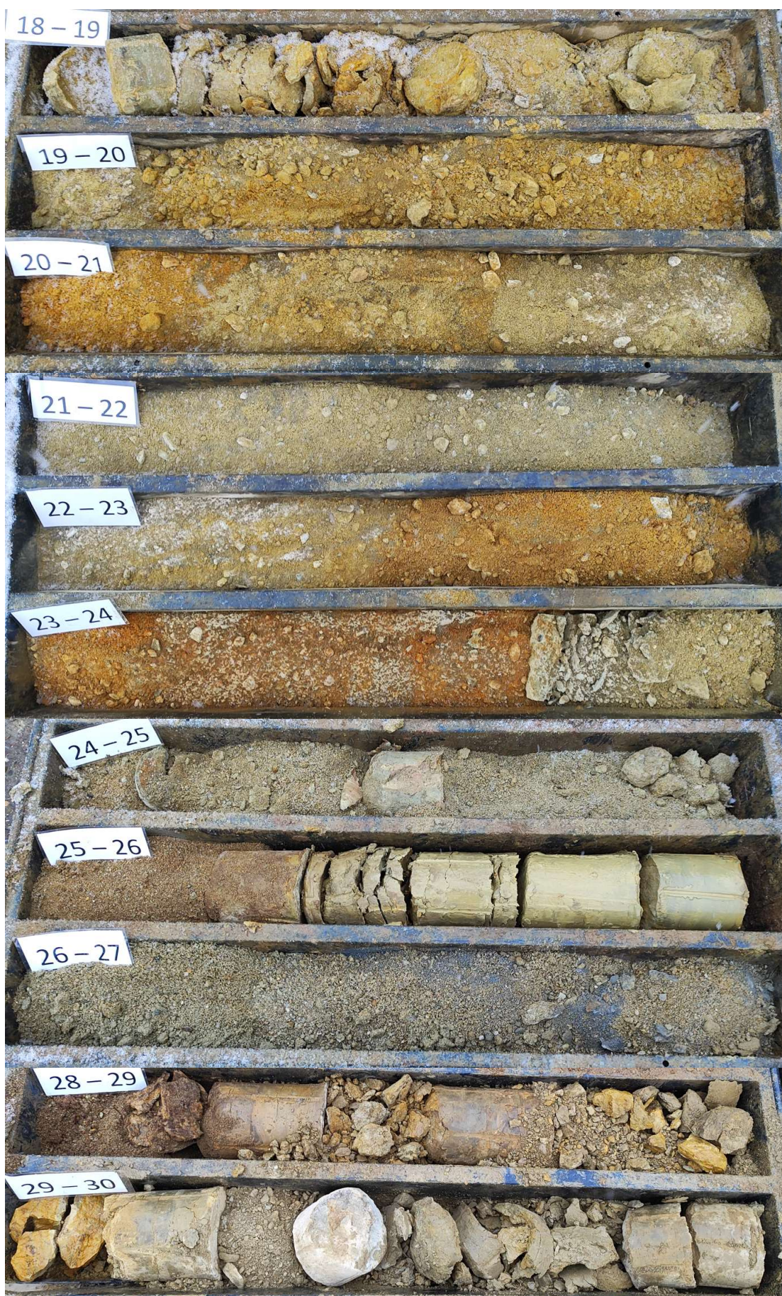
Foto 4: Jádru jádrového vrtu JV1.
