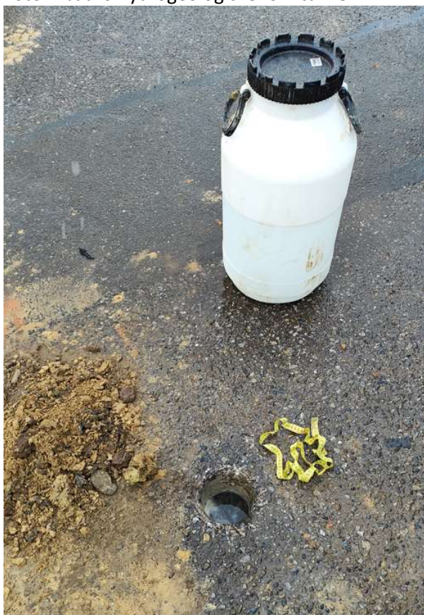
Foto 2: Realizace vsakovací zkoušky v hydrogeologickém vrtu HG1.
