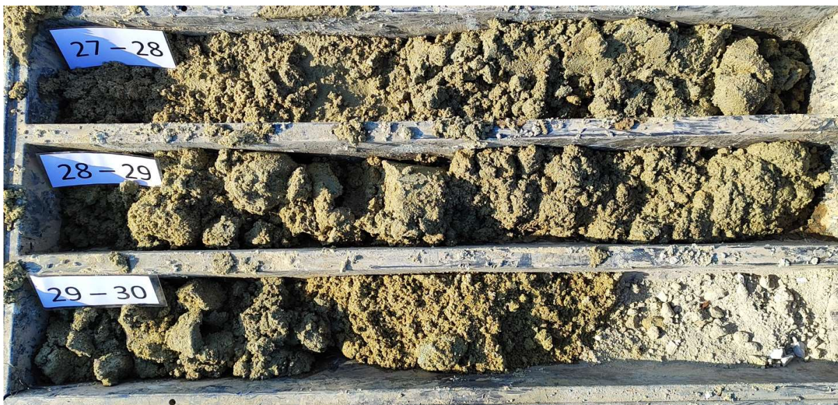
Foto 5: Jádro jádrového vrtu JV2.
